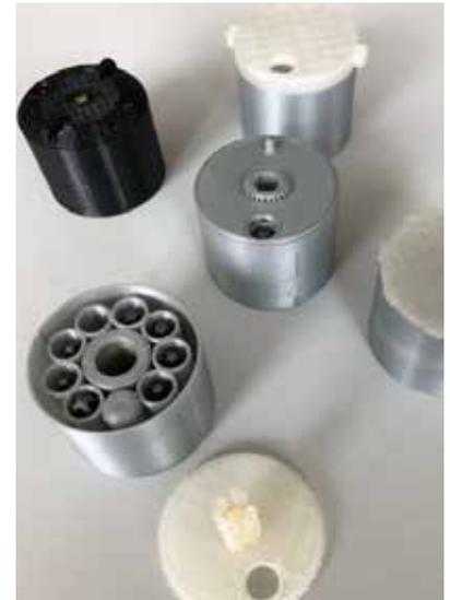
Prototypen der Bithalter in 3D-Druck
